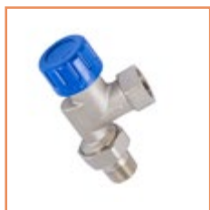
Клапан зворотного потоку нікельований, фігура кутова DN 15 GZ 1/2xGW1/2
